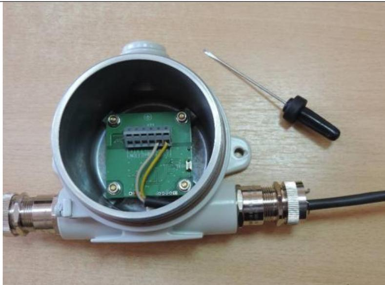
Рисунок В.3 – Коробка ККВ14 с кабелем (кабель показан для примера)
